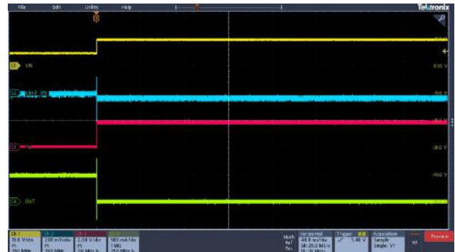
图 10-6 过压保护响应 V_{IN} = 5-10V , V_{BAT} = 3.8V , I_{BAT} = 500mA
