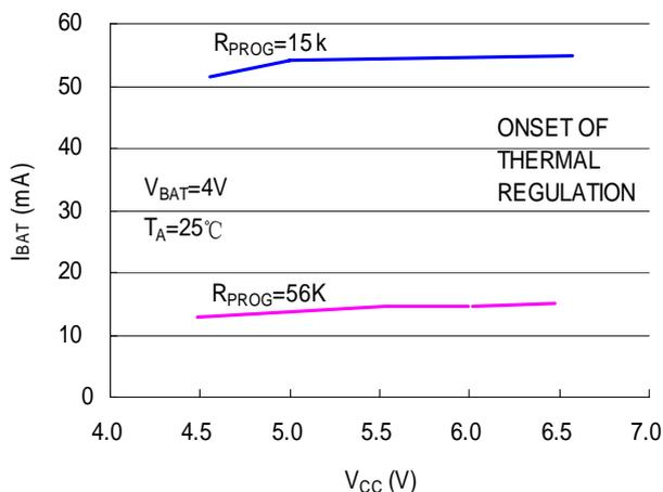
(涓流) 充电电流与电源电压关系曲线
