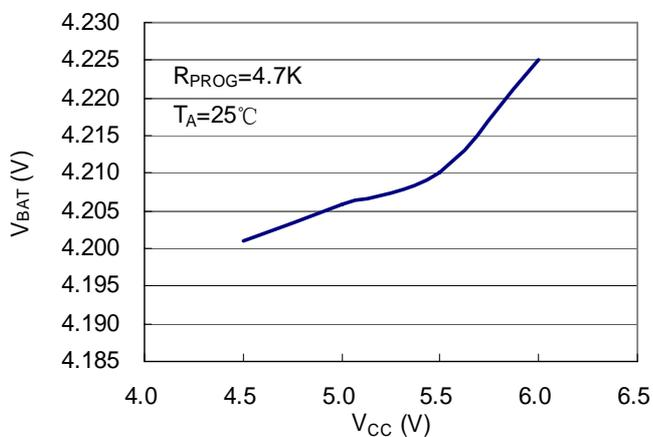
充电电流与电压关系曲线
