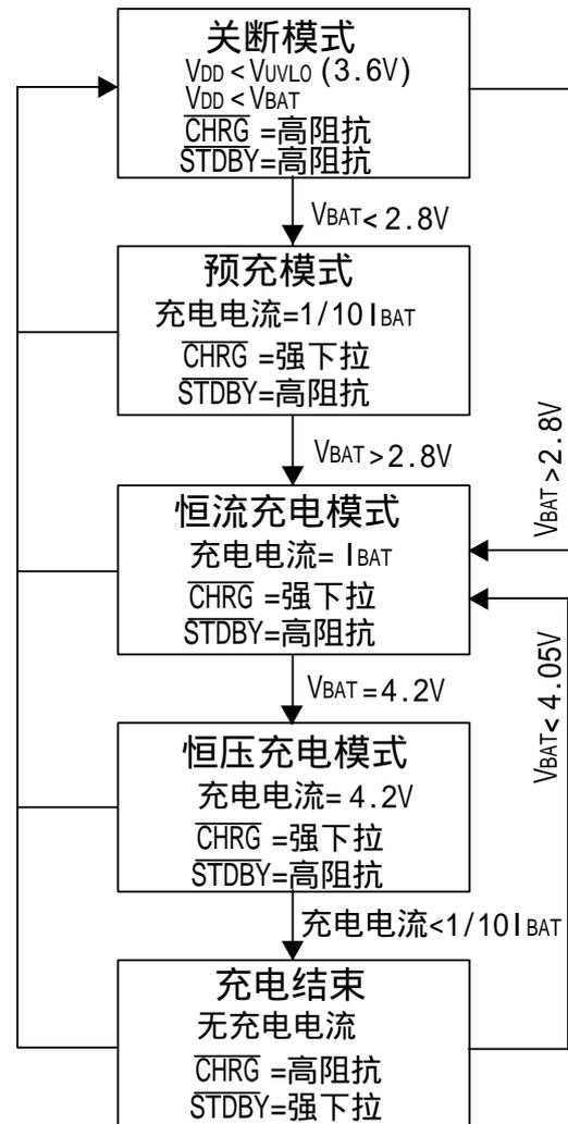
图 1: 一个典型充电循环的状态图
